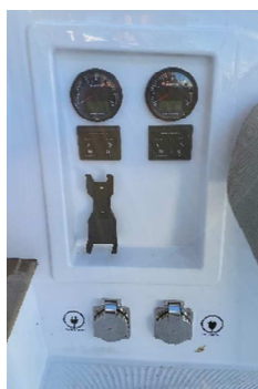
Prise de quai au poste de barre tribord
